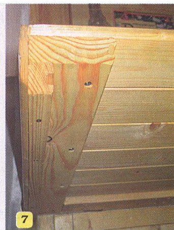
7 Торцы столешницы закрыты декоративными раскладками. Брусочки, закрепленные по краям столешницы, служат фиксаторами крайнего положения опор.
