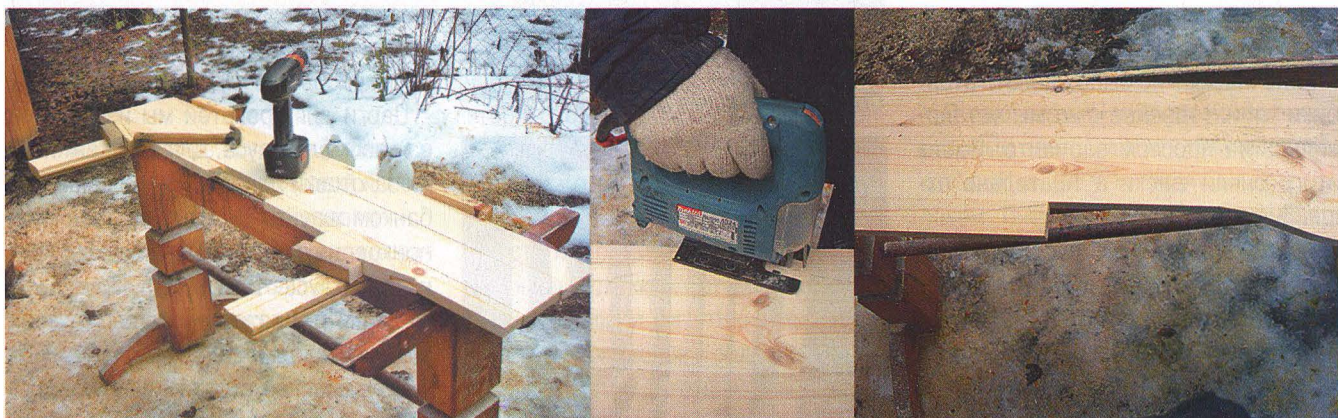
Изготовление заготовки для панели спинки кровати.
