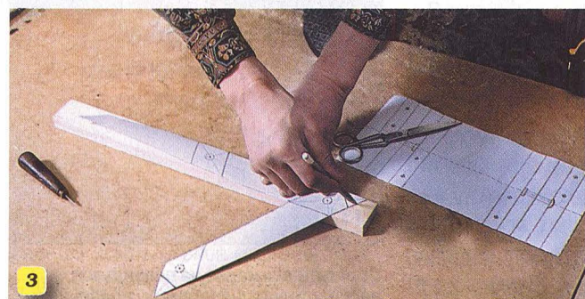
3 Наложите выкройку на заготовку, отчертите по ней линии реза, а затем наколите шилом точки сверления отверстий для осей шарниров.
