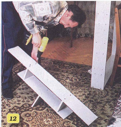
Верхний монтажный модуль. Прежде чем прикрепить его к основному блоку, нужно хорошо подтянуть верхние крепления — потом к ним с шуруповертом не подберешься.
