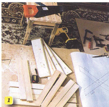
1 Немного рейки подходящего сечения, крепеж, обычный инструмент и несколько часов свободного времени — это все, что потребуется для работы.
